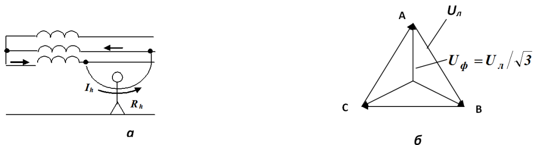
Рис. 1.12. Схема прохождения тока через тело человека при двухфазном прикосновении: а – общая схема; б – векторная диаграмма напряжений фаз относительно земли
